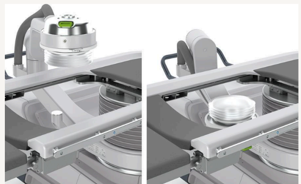
Figura 14: Izquierda: Cabeza terapéutica encima de la mesa / Derecha: Cabeza terapéutica debajo de la mesa.
