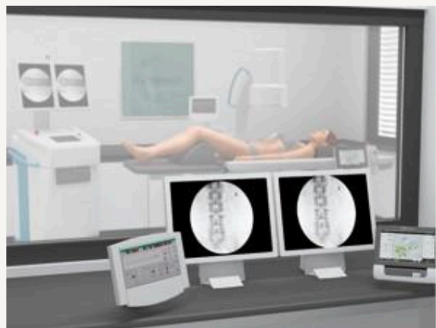
Figura 22: Mando a distancia del control y monitoreo total de todos los movimientos, parámetros terapéuticos y funciones radioscópicas.
