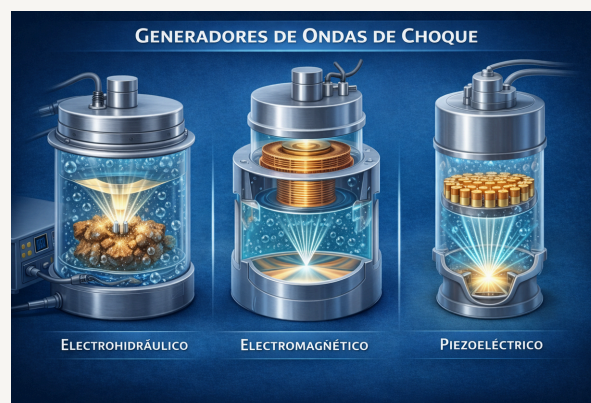
Figura 16 : Tipos de generadores de ondas de choque utilizados en la litotricia extracorpórea: electrohidráulico, electromagnético y piezoeléctrico, los cuales permiten la generación de pulsos acústicos de alta energía dirigidos hacia el cálculo para su fragmentación. (Elaboración propia)
