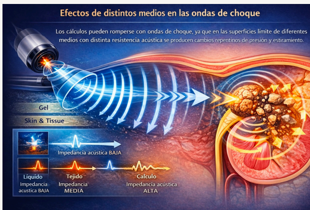
Figura 13: Generación, propagación y enfoque de ondas de choque en medios biológicos durante la litotricia extracorpórea. (Elaboración Propia)
