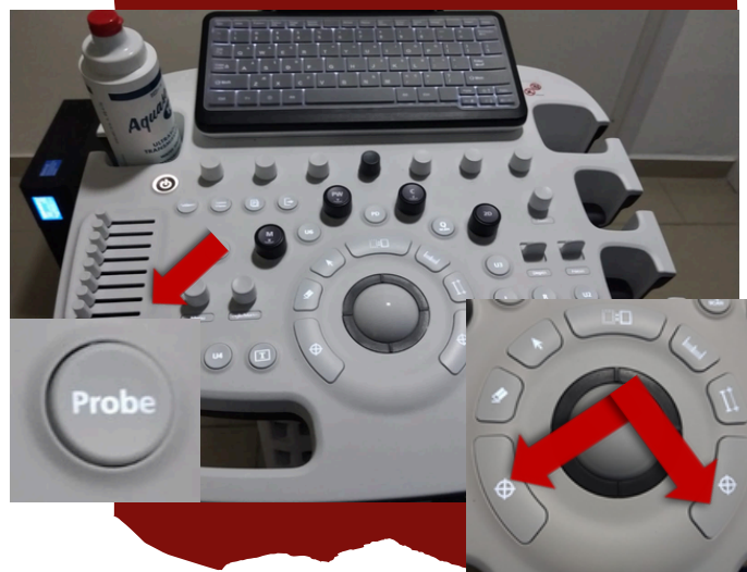
Figura 151. Botonería del ecógrafo, en esta imagen muestra que botón usar para Aceptar e iniciar el estudio.
