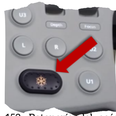
Figura 152. Botonera del ecógrafo, en esta imagen muestra que botón se debe pulsar u oprimir para congelar las imágenes.
