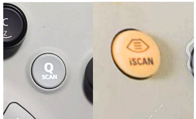
Figura 45. Qscan (QuickScan) Comúnmente etiquetado como "QScan", "QuickScan", "Auto Optimize", "iSCAN", o identificado mediante un ícono representativo (como una varita mágica o engranaje).
