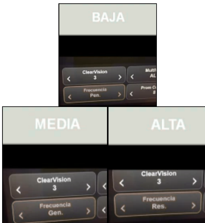
Figura 42. Frecuencia en Pantalla Táctil Frecuencia con valor según poder de penetración.
