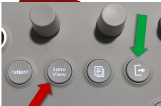
Figura 154. Botonera del ecógrafo, en esta imagen muestra que botón se debe pulsar u oprimir para gestionar las imágenes (flecha roja) seleccionar el examen y enviar al PACS, el de la flecha verde es para finalizar el estudio.
